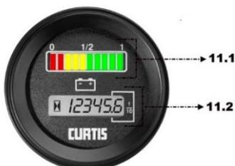
Состояние заряда аккумулятора отображается при помощи шкалы (11.1), состоящей из 10 секций с светодиодной индикацией. Каждое деление шкалы равнозначно 10% уровню заряда. Имеются 5 зеленых, 3 желтых и 2 красных светодиода. По мере разрядки аккумулятора светодиоды гаснут поочередно справа на лево. Счетчик рабочих часов (11.2) отображает продолжительность работы наполного подъемно-транспортного средства. Рабочие часы отсчитываются
