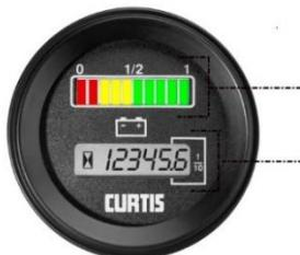
Состояние заряда аккумулятора отображается при помощи шкалы (11.1), состоящей из 10 секций с светодиодной индикацией. Каждое деление шкалы равно значно 10% уровню заряда. Имеются 5 зеленых, 3 желтых и 2 красных светодиода. По мере разрядки аккумулятора светодиоды гаснут поочередно справа налево. Счетчик рабочих часов (11.2) отображает продолжительность работы напольного подъемно-транспортного средства. Рабочие часы отчитываются
