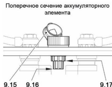
Качество воды для доливки электролита должно соответствовать очищенной или дистиллированной воде. Высота уровня электролита не должна опускаться ниже минимальной отметки уровня электролита (9.16) и не может превышать отметку максимального уровня (9.17)!
