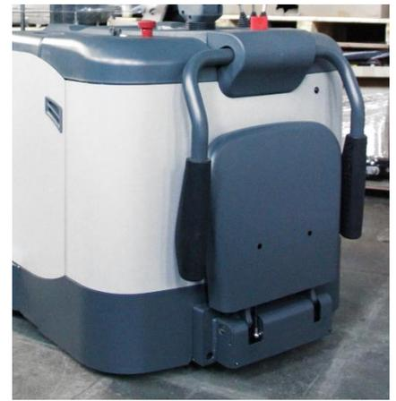
Платформа, как и поручни, интегрированы в общую систему безопасности и блокируют движение при отсутствии оператора на платформе
