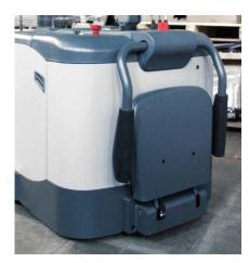
Платформа, как и поручни, интегрированы в общую систему безопасности и блокируют движение при отсутствии оператора на платформе
