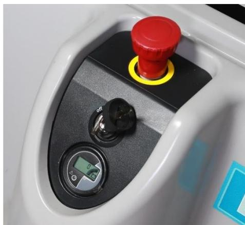
Аварийная кнопка, индикатор заряда и ключ зажигания в зоне видимого контроля оператора
