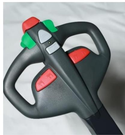
Кнопка защиты оператора для безопасной работы. Функция «черепаший ход» для защиты оператора и груза в узких коридорах
