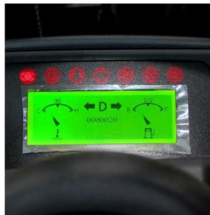
Многофункциональная LED панель со счётчиком моточасов для контроля своевременного технического обслуживания.
