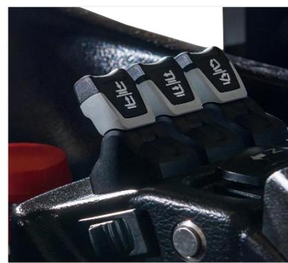
Манипуляторы (FINGERTIP) для управления движением и гидравлическими функциями. Установлены под правую руку оператора для комфортной работы.
