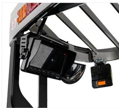
TISEL FORKVIEW SYSTEM – система видеоконтроля с 7-ми дюймовым цветным монитором высокой четкости для отслеживания положения вил.
