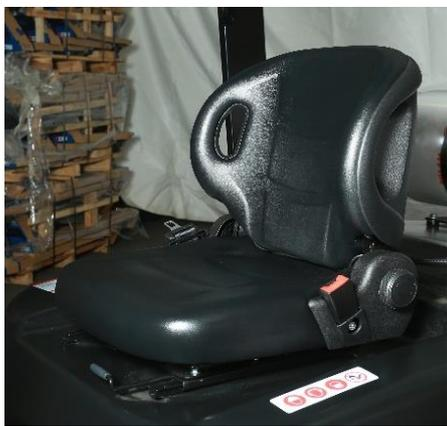
Встроенный в сиденье датчик присутствия не позволит погрузчику передвигаться без оператора.
